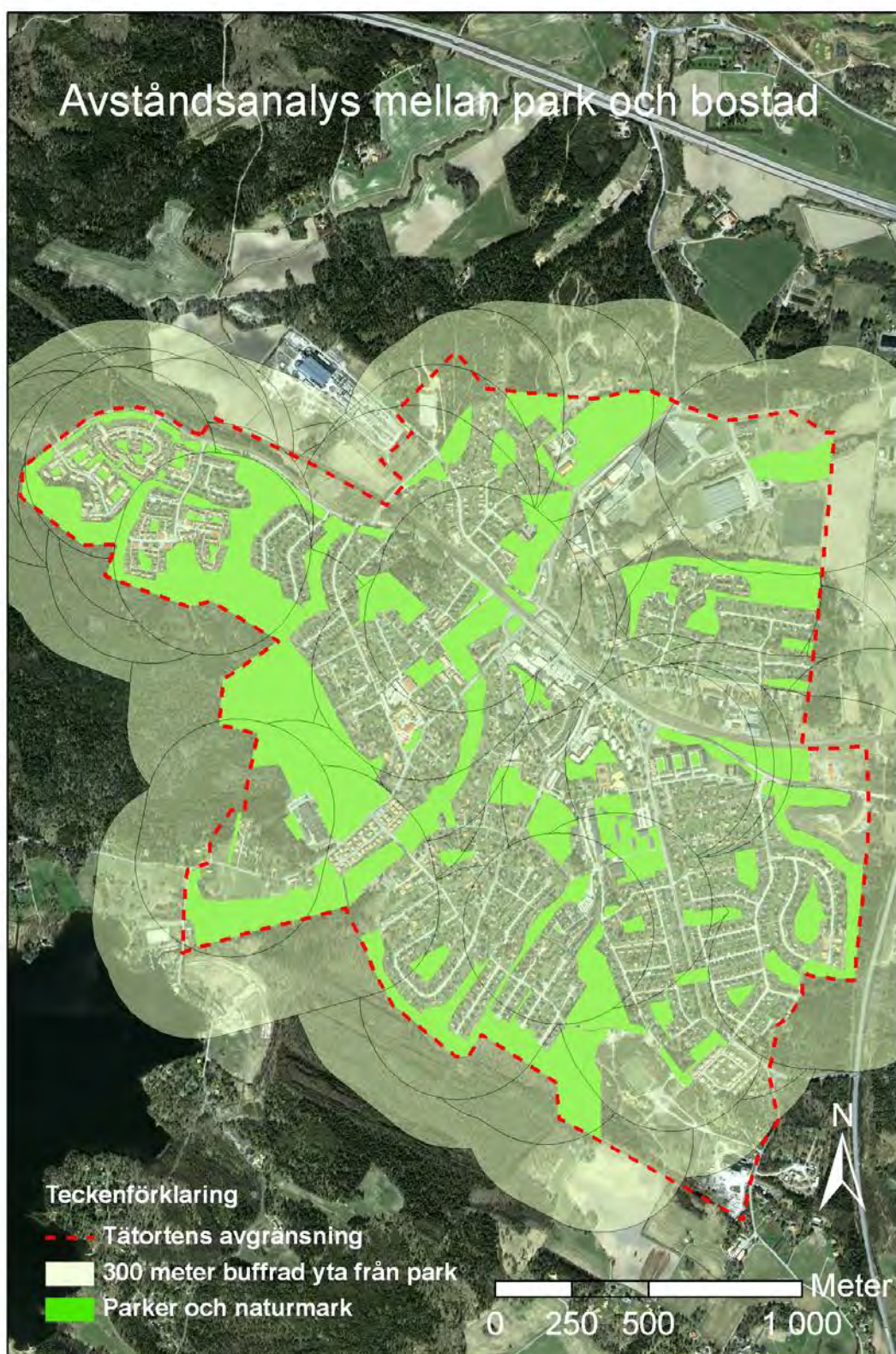
Figur 2. I en avståndsanalys för att studera avståndet mellan bostad och park har parkernas polygoner (de gröna ytorna) "buffrats". Ett nytt skikt framkommer, vilket illustreras som transparent med svaga svarta gränser.
