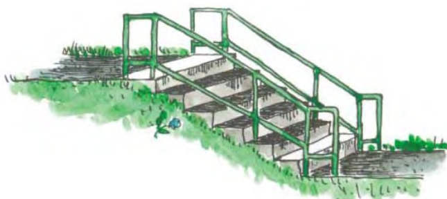
Figur 10. Principutformning av trappa (Stockholms stad, 2001).
