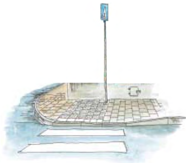
Figur 8. Utformning av övergångsställe enligt Stockholmsmodellen (Stockholms stad, 2001).
