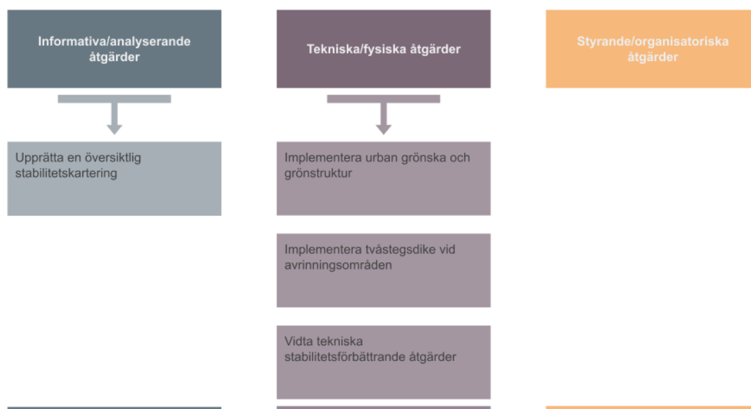
Figur 16. Åtgärdsförslag kopplade till erosionsprocesser.
